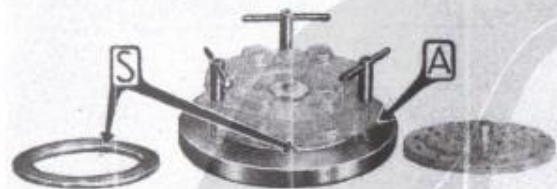
Fig. 54. - A -- Attrezzo A. 10112 per smontaggio, rimontaggio e registrazione della frizione. S -- Anelli di spessore.
