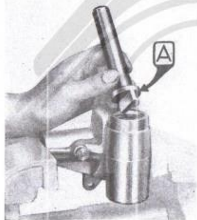
Fig. 96. - A = Attrezzo A. 10111 per smontaggio anello esterno cuscinetto a rulli posteriore scatola guida.
