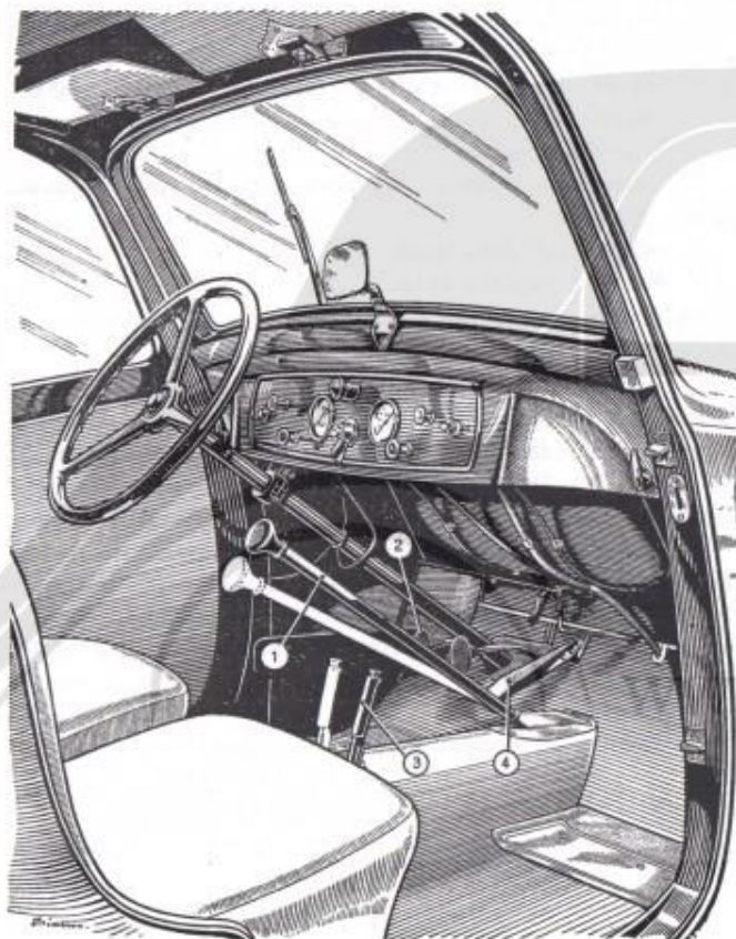
Fig. 13. — Posición de los mandos de la puesta en marcha del coche.
