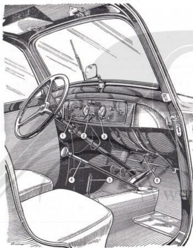
Fig. 12. — Posición de los mandos de arranque en frío del motor.
