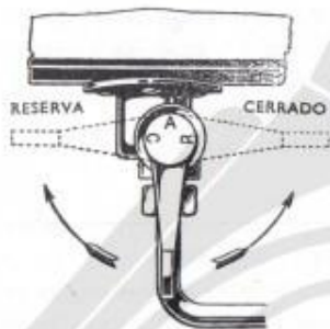
Fig. 11. — Grifo del depósito de la gasolina en posición de abierto. A. Abierto. - R. Reserva. - C. Cerrado.
